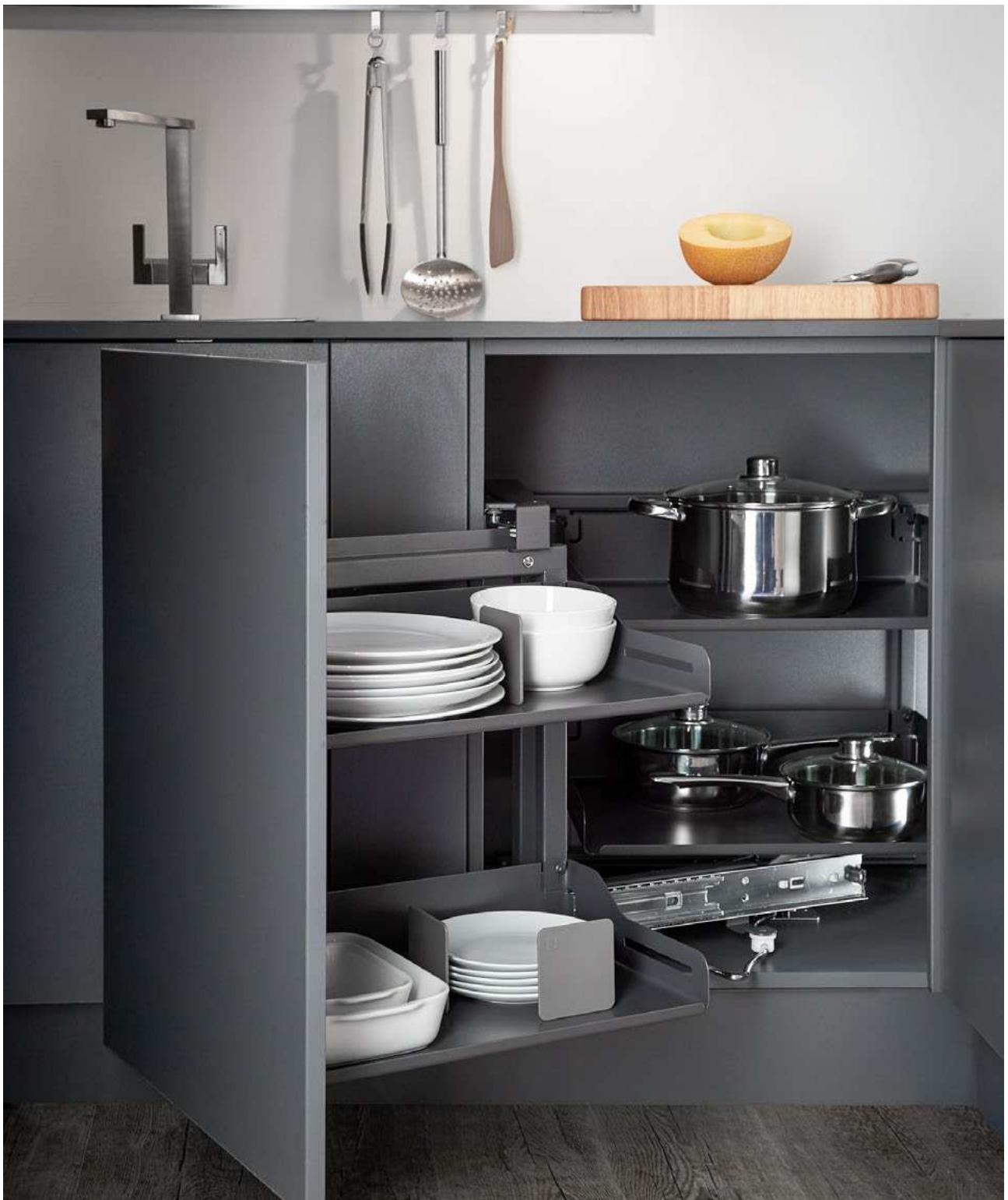
Système coulissant d'angle Magic Corner Standard : La façade de la porte et les étagères fixées dessus pivotent de côté et les étagères arrière sortent automatiquement du coin pour être ramenées au centre de l'armoire.
